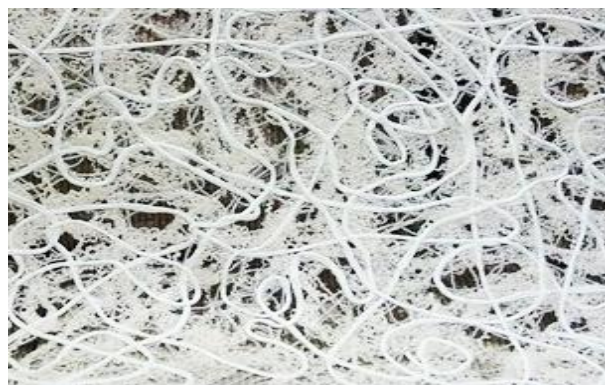
Figura 3. Tecido criado segundo a técnica da colagem, com resíduo de fios de malharia retilínea com resíduos de ourela e cordões de algodão.
